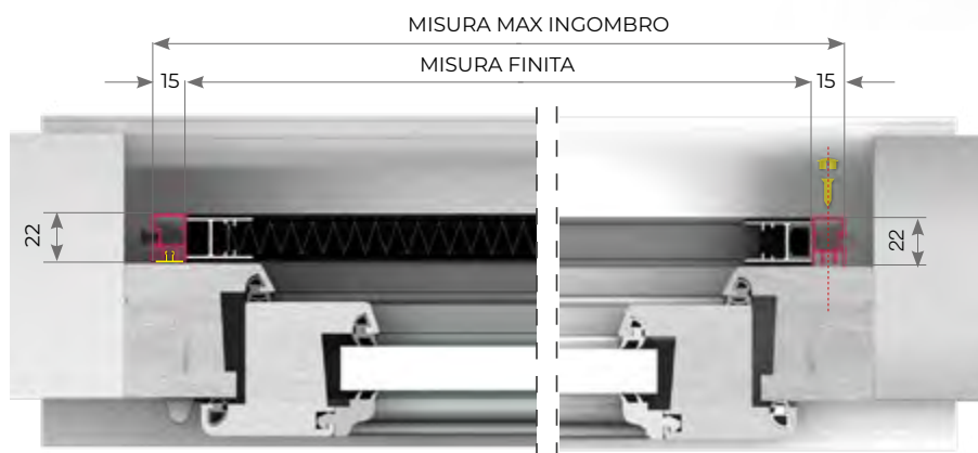
SEZ. ORIZZONTALE FISSAGGIO CON CLIP
